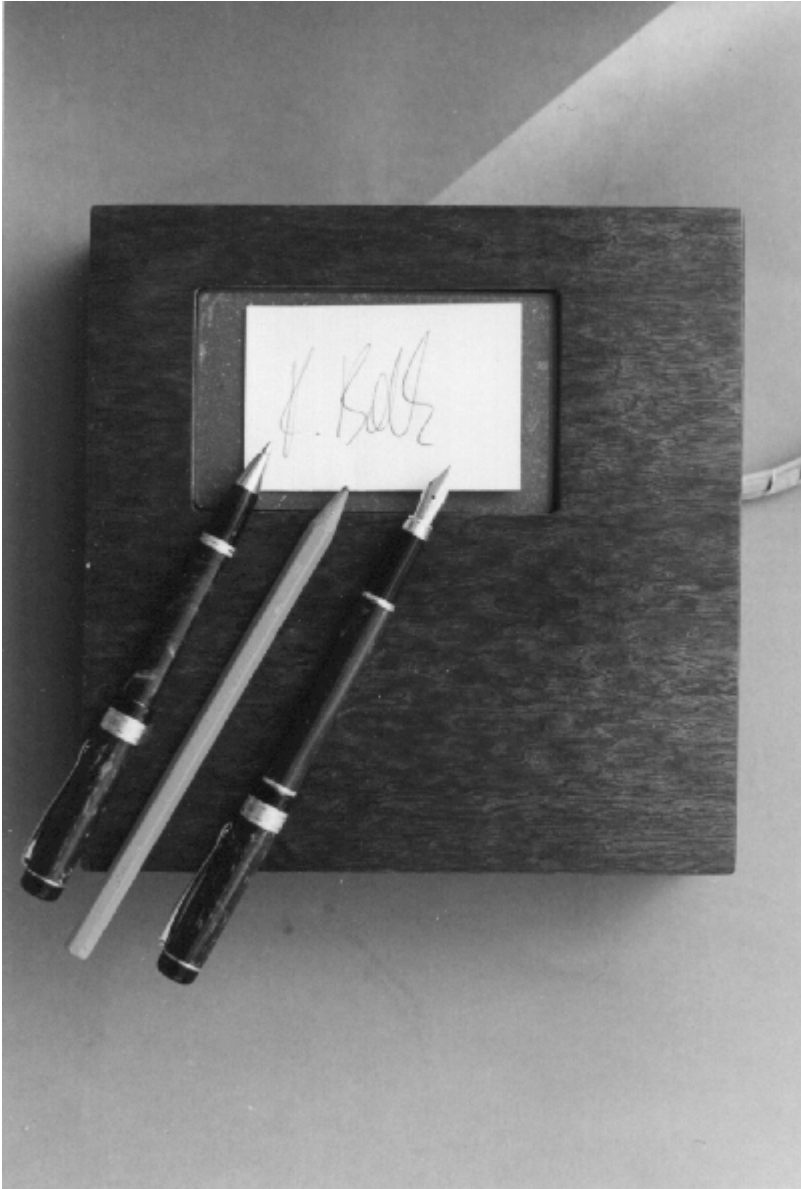
Abb. 1: HESY - Ein Unterschriftenprüfer auf Basis der Schreibdynamik, benutzbar mit Normalstiften.
